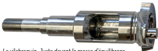
Le vilebrequin. Juste devant la masse d'équilibrage et le maneton, apparaît la gorge fraisée qui sert de chemin de roulement pour les billes du roulement arrière.
