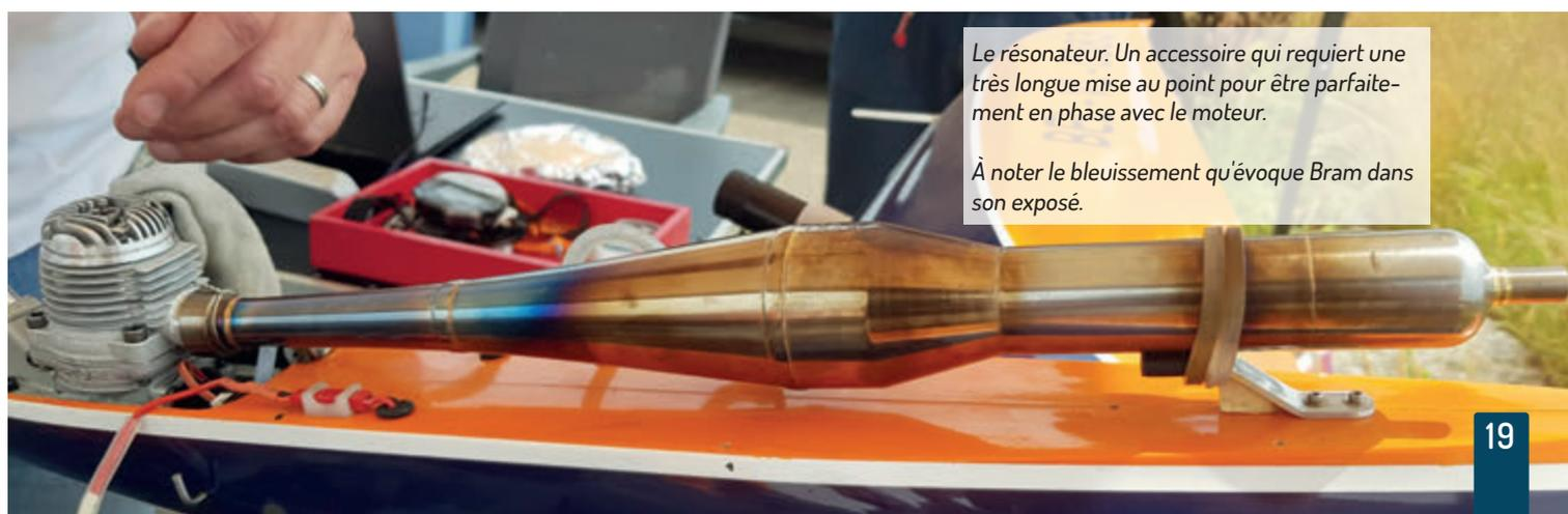
*Le résonateur. Un accessoire qui requiert une très longue mise au point pour être parfaitement en phase avec le moteur.*
