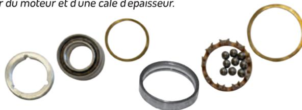
Le roulement arrière dont on aperçoit à l'avant-plan la bague extérieure, ensuite la cage et les billes et enfin une cale d'épaisseur. La bague intérieure n'existe pas, les billes circulent directement sur l'arbre du vilebrequin.
